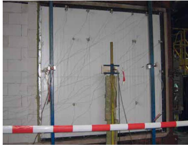
Testopstelling bij Efectis in Nederland waarbij het KS1000CS paneel van 175 mm een brandweerstand van 60 minuten behaalde.
